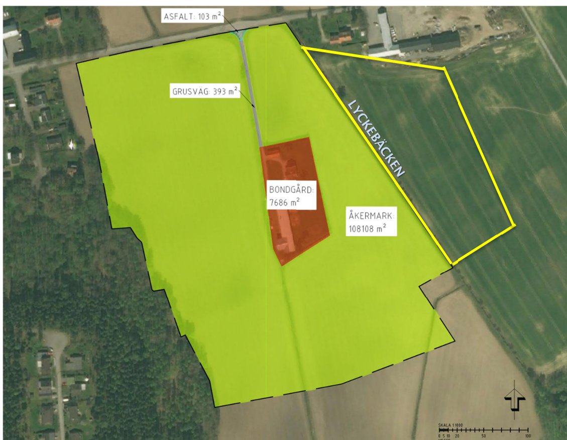
Figur 12. Befintlig markanvändning inom planområdet: åkermark (gul-grön färg), bondgård (röd färg), grusväg (grå färg) och asfalt (skrafferat). Tillagt tillrinningsområde mot Lyckebacken i gul färg.
