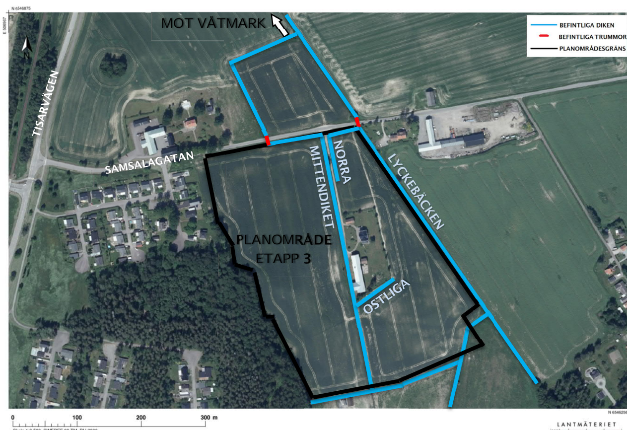
Figur 3. Flygbild över planområdet för Samsala etapp 3 (svart). Befintliga diken är markerade i blått och befintliga trummor i rött.
