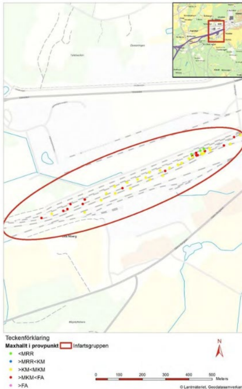
Figur 25: Översiktskarta för befintlig infartsgrupp inklusive växlarna som illustrerar föroreningsituationen i finmaterialet i ballasten. Färgerna visar maxhalt i provpunkten. Bilden visar provpunkter i infartsgruppen.
