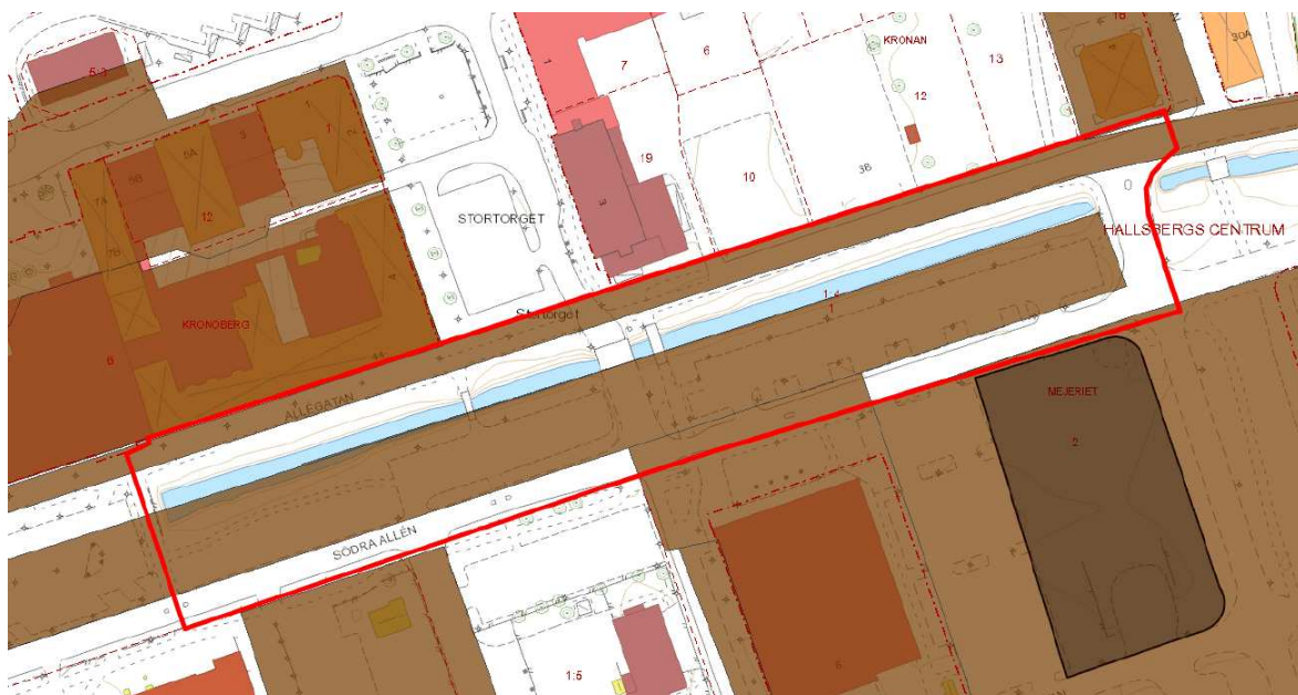
Figur 5. De bruna områdena visar var geotekniska undersökningar genomförts inom området. Röd linje visar plangränsen.
